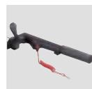
L'impugnatura della barra semi e multi funzionale offre la possibilità di spegnimento, cambio marcia, regolazione del gas e regolamento elettrico dell'inclinazione (PTS: solo sui modelli con tilt elettroidraulico) integrati nell'impugnatura della barra di comando per una maggiore comodità.
